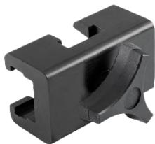
La bride pour rail STERIS est une bride pour rail standard utilisée pour fixer n'importe quel accessoire à tige plate au rail latéral de la table. À installer au niveau des encoches du rail latéral. Ces brides sont incluses avec nos deux modèles (standard et bariatrique) d'étriers PowerLift. Compatible avec tous les accessoires de 2,5 cm x 0,6 cm dotés de lames de montage plates. Vendue individuellement.
