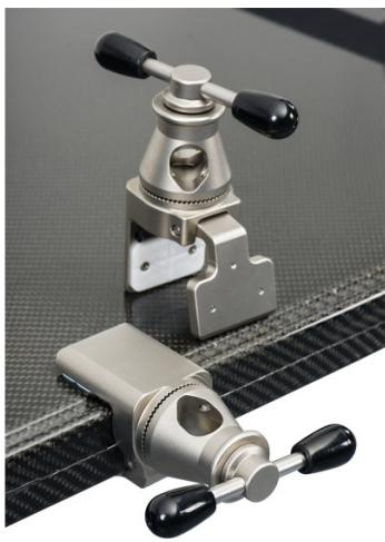
La bride rotative pour CMAX X-Ray est idéale pour monter des accessoires à montants ronds de max. 1,9 cm de diamètre n'importe où sur le périmètre de la table en l'absence d'un rail latéral. La poignée de la douille rotative permet de contrôler la hauteur et l'angle. Le levier simple facilite la fixation et le retrait rapide des accessoires. Le réglage de la douille permet d'installer et de fixer des accessoires multiplans à n'importe quel angle (ex. appui-bras multi-axe).
