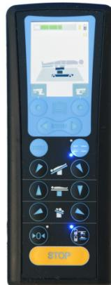
La commande manuelle CMAX X-Ray est dotée d'un écran LCD offrant un retour visuel instantané sur le positionnement et le diagnostic. Fonctionne en association avec la commande joystick. Ses fonctionnalités incluent des boutons d'articulation haut/bas, Trendelenburg/Trendelenburg inversé, inclinaison gauche/droite, mise à l'horizontale du plateau de la table, déplacement de la table, verrouillage/déverrouillage des freins au sol et orientation inversée.
