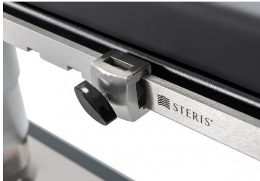
Los bloqueos para rieles laterales STERIS son bridas de bloqueo compactas clásicas utilizadas para fijar accesorios de mesa con barra plana a los rieles laterales estándar de las mesas de cirugía. Los bloqueos para rieles laterales con muescas ofrecen dos opciones de conexión para poder fijar los accesorios en posición horizontal o en posición vertical. El tornillo de agarre permite asegurar el accesorio y la brida a la mesa. Se venden por pares.
