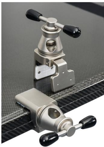
La brida giratoria para CMAX X-Ray es ideal para montar accesorios con soportes redondos de hasta 1,9 cm de diámetro en cualquier parte del perímetro de la mesa cuando no hay un riel lateral. La empuñadura de la pieza giratoria permite controlar la altura y el ángulo. La palanca sencilla facilita la fijación y la retirada rápida de los accesorios. El ajuste de la pieza permite instalar y fijar accesorios multiplanos en cualquier ángulo (por ejemplo, soporte para brazo multi-eje).
