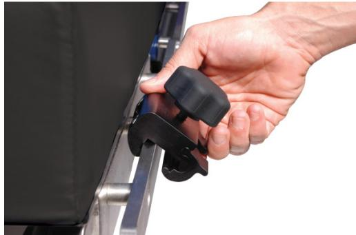
La brida de hoja con clip se puede utilizar para asegurar accesorios de mesa quirúrgica con barra plana a los rieles laterales de la mesa. Su palanca de liberación rápida y sencilla permite montar la brida en cualquier punto del riel. Compatible con todos los accesorios de 2,5 cm x 0,6 cm con hojas de montaje planas.
